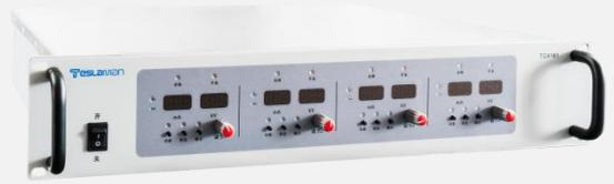
泰思曼 TC4161 系列高压电源, 在药液电导率高于  $0.1 \mu\text{S}/\text{cm}$ , 药瓶漏孔大于  $2 \mu\text{m}$  的检漏场合下, 通过能量脉冲检测法, 使好/坏瓶所产生 10 倍以上的能量差异, 精准识别好/坏瓶。实测检出率和漏检率优于万分之一, 检出速度大于 600 瓶/min。
