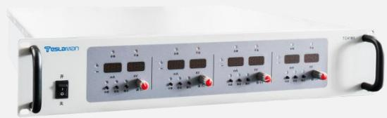
泰思曼 TC4161 系列高压电源，专为大批量生产塑料件的质量控制测试生产线开发，还可用于瓶盖等塑料件的缺陷检测，可检测产品局部成型断层、膜层厚度不足及穿孔等缺陷，最小检测范围低于  $10\ \mu\text{m}$ 。
